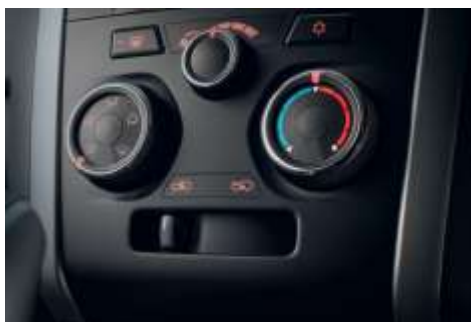
Régulation manuelle de la climatisation.
