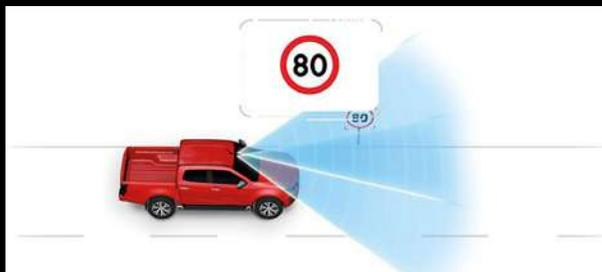
**TSR (Traffic Sign Recognition).** Das TSR-System erfasst die Verkehrsschilder und zeigt sie auf dem Display des Armaturenbretts an, so dass der Fahrer über Einschränkungen und Regelungen auf den Strassen informiert ist.
