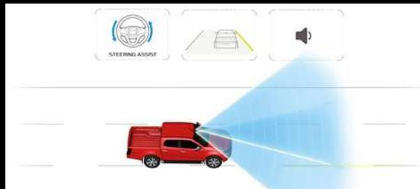
**LDP (Lane Departure Prevention).** Das LDP-System greift leicht in das Lenkrad ein, um das Fahrzeug bei unbeabsichtigtem Verlassen der Fahrspur wieder auf die richtige Fahrspur zu bringen.
