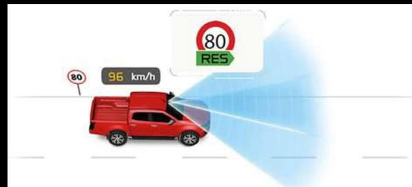
**ISL (Intelligent Speed Limiter).** Das ISL-System passt die Geschwindigkeit des Fahrzeugs automatisch an die erfassten, auf den Verkehrsschildern angegebenen Grenzwerte an und hält die Geschwindigkeit innerhalb der gesetzlichen Grenzen.
