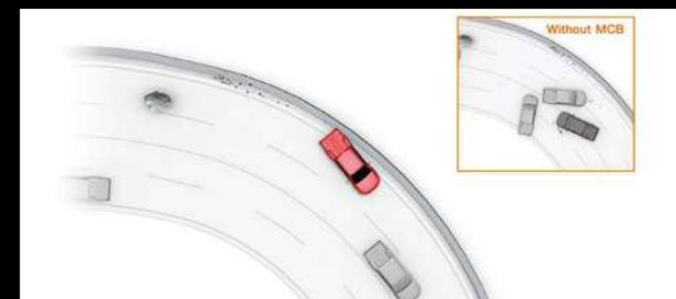
**MCB (Multi-Collision Brake).** Das MCB-System bremst automatisch nach einem ersten Aufprall, wodurch die Gefahr von Folgeunfällen verringert und die Gesamtsicherheit des Fahrzeugs erhöht wird.
