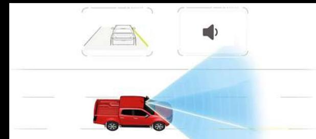
**LDWS (Lane Departure Warning System).** Das LDW-System warnt den Fahrer, wenn das Fahrzeug im Begriff ist, die Fahrspur zu verlassen, ohne ein Signal zu geben, und hilft so, Unfälle durch unbeabsichtigtes Verlassen der Fahrspur zu vermeiden.
