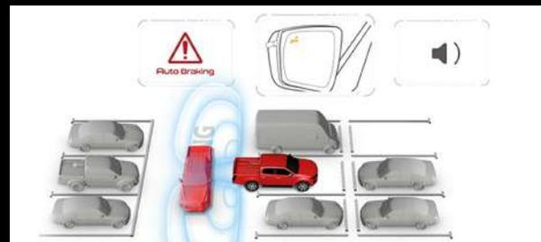
**RCTA (Rear Cross Traffic Alert) + RCTB (Rear Cross Traffic Brake).** Das RCTA-System warnt den Fahrer beim Rückwärtsfahren vor von der Seite herannahenden Fahrzeugen und verhindert so Kollisionen. Das RCTB-System bremst das Fahrzeug beim Rückwärtsfahren ab, um Kollisionen zu vermeiden, wenn es ein sich von der Seite näherndes Fahrzeug erfasst. **(Die Systeme RCTA und RCTB sind nur für die Modelle F+ und NITRO SPORT für die Version Space erhältlich).**
