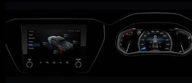
**TPMS (Tyre Pressure Monitoring System).** Das System ermöglicht es, den Reifendruck des Fahrzeugs auf dem Display des Armaturenbretts zu überwachen und den Fahrer bei Abweichungen, die die Fahrsicherheit beeinträchtigen könnten, zu informieren.
